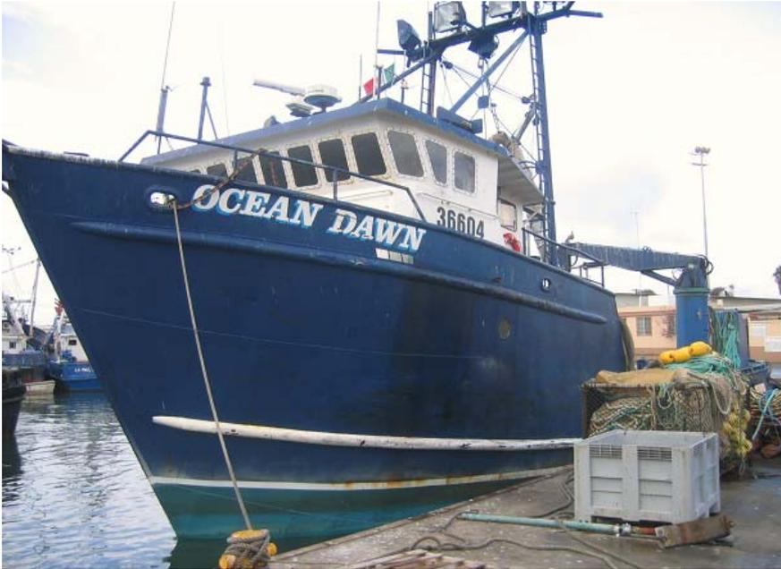
写真：イワシまき網漁船？魚倉60トン、夜間操業の投光器を付けている。
