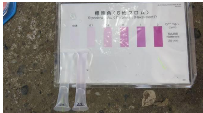
六価クロム簡易検知管による検査結果。右がラウェウ川の検体色になる（ヌ八郡／2022年7月）
