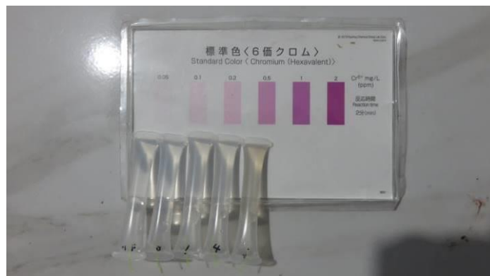
六価クロム簡易検知管による検査結果。一番右が家庭用水として利用している湧水の検体（トウティ郡／2022年10月）
