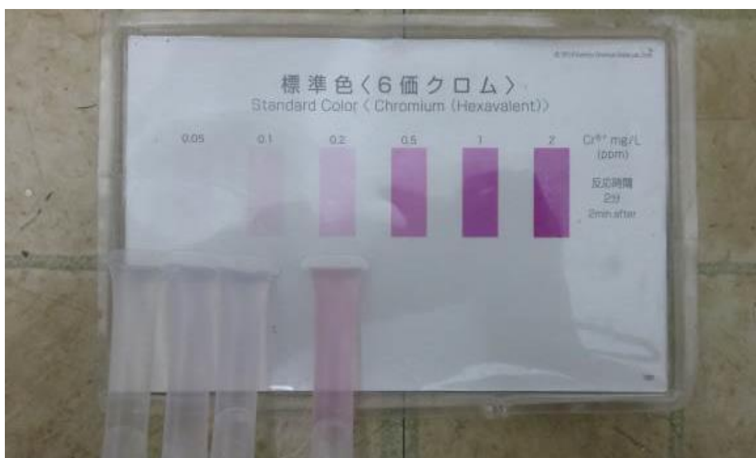
トグボン川での六価クロム簡易検知管検査の結果（0.2mg/L）（2019年10月雨季、FoE Japan撮影）
